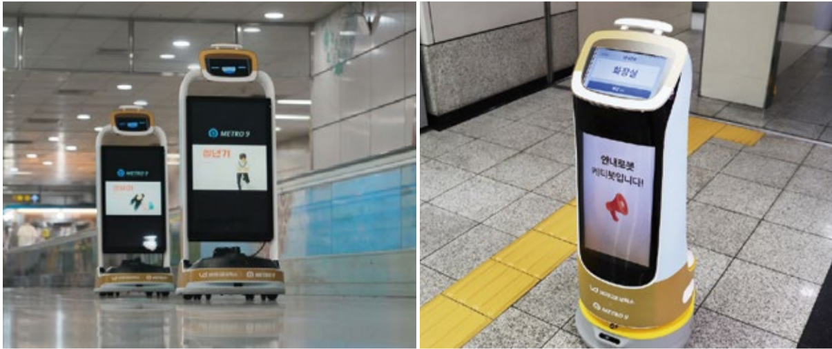
브이디로보틱스가 9호선 동작역과 노량진역에서 실증을 진행하고 있는 광고 로봇 푸두봇 프로(왼쪽)와 안내 로봇 케티봇의 모습.
