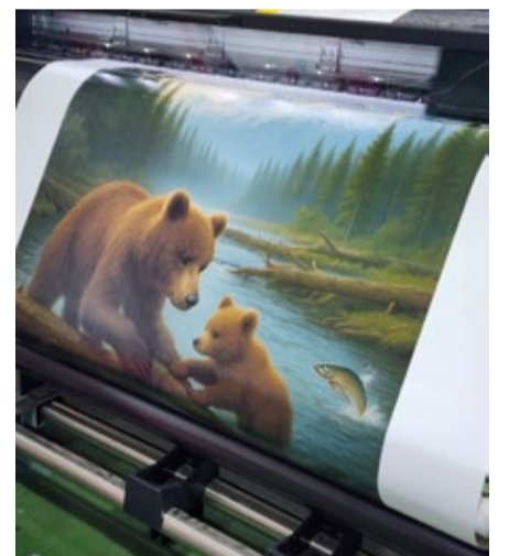
UV 프린터로 고무자석 시트에 이미지를 출력하고 있는 모습.
